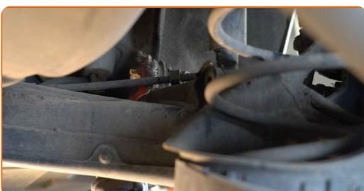
**11** Svita l'elemento di fissaggio che collega il tirante della barra stabilizzatrice al braccio di controllo. Utilizza una chiave a bussola N°21. Usa una chiave a cricchetto.
