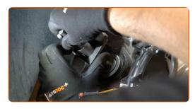
Montare la pinza del freno e fissarla. Utilizza una chiave combinata N°17. Utilizza una chiave a bussola N°13. Usa una chiave dinamometrica. Serralo fino allo coppia di torsione di 35 Nm.
