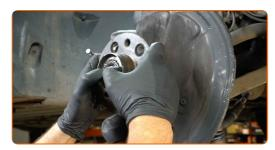
Pulire la sede di montaggio del mozzo della ruota. Usa un detergente spray multiuso.
