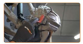
Svitare l'attacco della pinza freno. Utilizza una chiave combinata N°17. Utilizza una chiave a bussola N°13. Usa una chiave a cricchetto.
