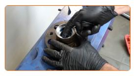
Installare la pista di rotolamento interna del cuscinetto della ruota nel mozzo. Usa un set di montaggio/smontaggio cuscinetti e boccole.
