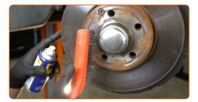
Svitare l'attacco del disco freno. Usa la chiave Torx T30. Usa un cacciavite a percussione.
