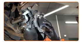
Serrare il sostegno pinza freno. Utilizza una chiave a bussola N°21. Usa una chiave dinamometrica. Serralo fino allo coppia di torsione di 115 Nm.
