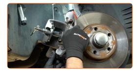
Pulisci gli elementi di fissaggio del disco freno. Usa una spazzola metallica. Usa lo spray WD-40.
