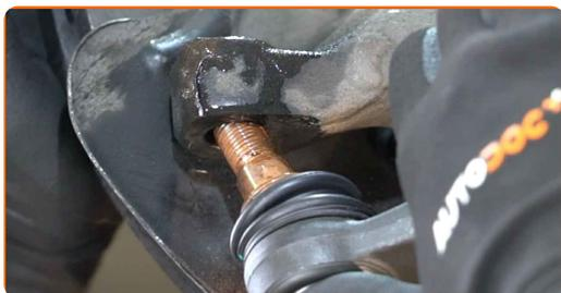
**15** Avvita il dado di serraggio che collega le testine tiranti dello sterzo al fuso a snodo. Utilizza una chiave a bussola N°21. Usa una chiave a cricchetto.
