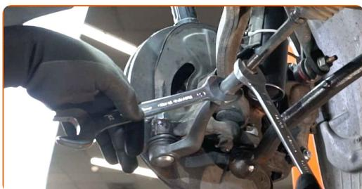
**17** Misura e memorizza la posizione precisa del giunto sferico sulla barra di accoppiamento, oppure conta il numero di giri completi al fine di evitare il disallineamento durante il montaggio successivo. Usa un calibro a corsoio.
