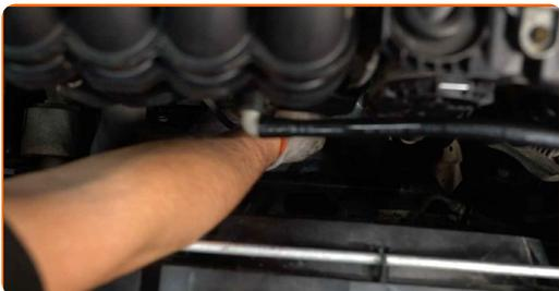
**9** Avvitare le nuove candele e serrarle. Usa la chiave a bussola per candele numero 16. Usa una chiave dinamometrica. Serralo fino allo coppia di torsione di 27 Nm.
