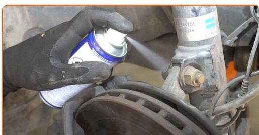
**17** Svitare l'elemento di fissaggio superiore che collega il puntone ammortizzatore al fuso a snodo dello sterzo. Usa una chiave HEX N.H12. Utilizza una chiave a bussola N°21. Usa una chiave a cricchetto. Usa un giramaschi.
