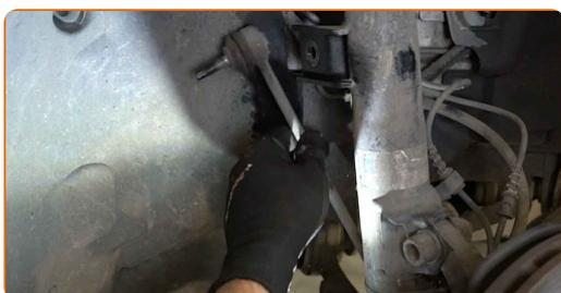
**13** Scollegare la staffa di fissaggio del tubo flessibile del freno. Usa delle tenaglie.
