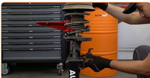
Sostituzione: ammortizzatore a molla - MERCEDES-BENZ CLK Cabriolet (A209). Gli esperti di AUTODOC raccomandano:
