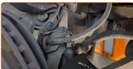
**14** Scollegare il cablaggio del sensore ABS.
