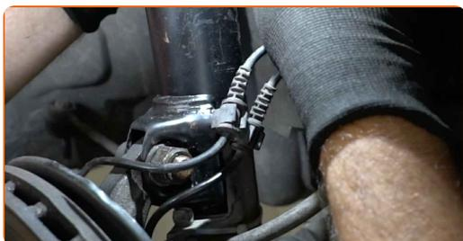
**62** Pulisci le sedi di montaggio del tirante della barra stabilizzatrice. Usa una spazzola metallica. Usa lo spray WD-40.
