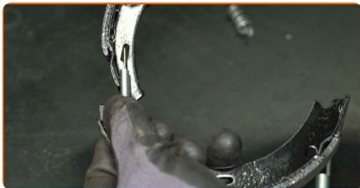
**28** Installare il regolatore del freno di stazionamento.
