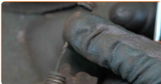
**25** Rimuovere le ganasce del freno di stazionamento.
