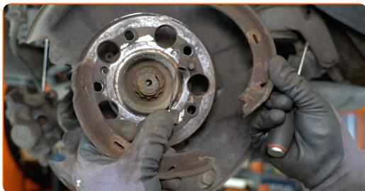
**26** Pulire le sedi di montaggio delle ganasce del freno di stazionamento. Usa una spazzola metallica. Usa un detergente spray multiuso.
