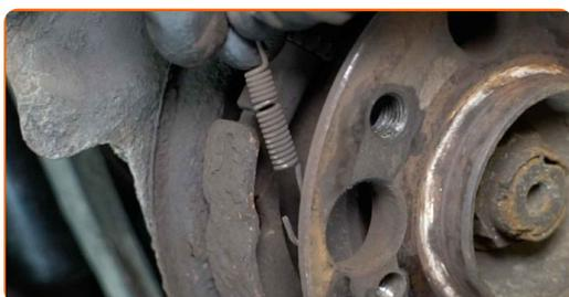
**22** Rimuovere le molle di fermo delle ganasce del freno di stazionamento. Utilizzare pinze a naso lungo.
