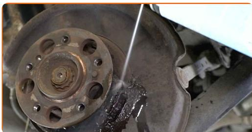
**27** Installare la molla di ritorno della ganasce superiore del freno.
