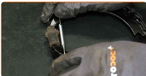
**29** Installare le nuove ganasce del freno di stazionamento.
