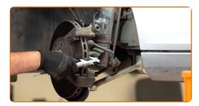
Pulisci le macchie di grasso vecchio e di ruggine, se ce ne sono, dai perni guida della pinza e dai parapolveri dei perni guida. Usa un pulitore freni.
