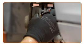
Installa il tubo flessibile del freno alla nuova pinza freno.
