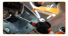
Serra gli elementi di fissaggio del tubo flessibile del freno. Utilizza una chiave combinata N°14. Usa una chiave dinamometrica. Serralo fino allo coppia di torsione di 18 Nm.
