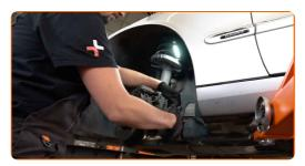
Svitare il tubo flessibile del freno dalla pinza del freno.
