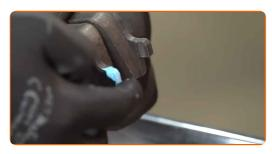
26 Installa i perni guida nel supporto della pinza freno.
