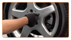
Rimettere il veicolo per terra e, lavorando in ordine incrociato, serrare i bulloni di fissaggio delle ruote. Usa una chiave dinamometrica. Serralo fino allo coppia di torsione di 110 Nm.
