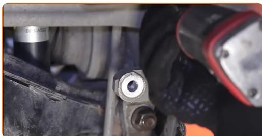
**23** Pulisci gli elementi di fissaggio dei tiranti delle barre stabilizzatrici. Usa una spazzola metallica. Usa lo spray WD-40.
