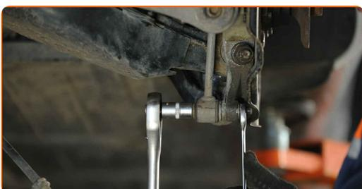
**78** Fissare il cavo freno di stazionamento.
