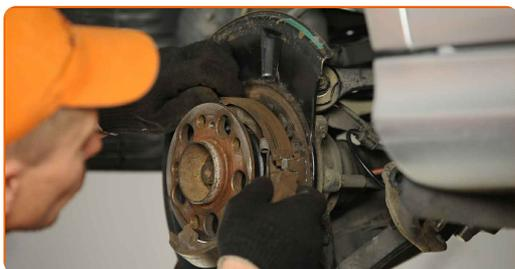
**80** Inserire il meccanismo di regolazione delle ganasce freno. Usa delle pinze. Usa delle pinze a becchi lunghi. Usa un giravite piatto.
