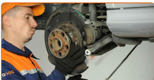
**53** Installa l'albero di trasmissione all'interno del mozzo della ruota.
