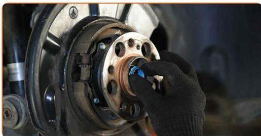
**82** Serrare l'attacco del mozzo. Utilizza una chiave a bussola N°32. Usa una chiave dinamometrica. Serralo fino allo coppia di torsione di 170 Nm. +45°
