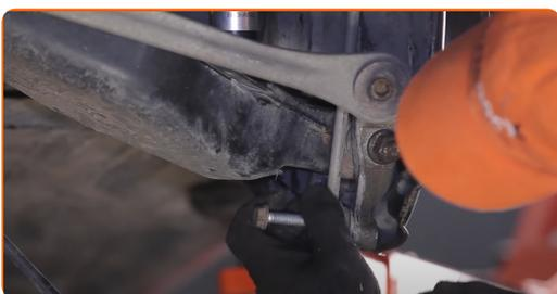
**77** Serra gli elementi di fissaggio del tirante della barra stabilizzatrice. Utilizza una chiave combinata N°16. Utilizza una chiave a bussola N°16. Usa una chiave dinamometrica. Serralo fino allo coppia di torsione di 50 Nm.
