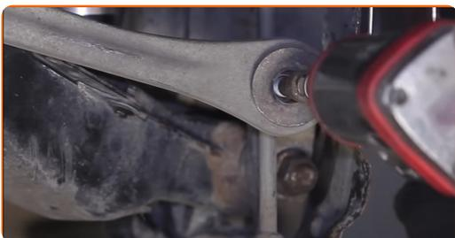
**68** Puntellare il fuso a snodo. Usa un cric idraulico per trasmissione.
