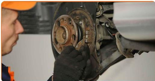
**79** Installare le ganasce freno di stazionamento insieme alla molla inferiore.
