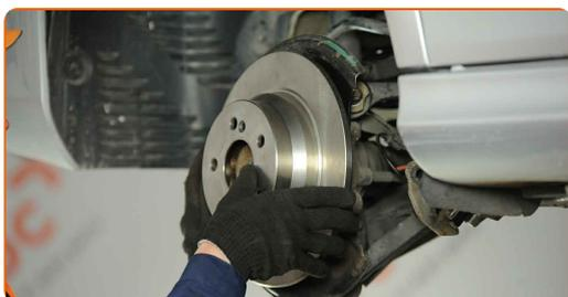
**85** Serrare l'attacco del disco freno. Usa la chiave Torx T30. Usa una chiave dinamometrica. Serralo fino allo coppia di torsione di 9 Nm.
