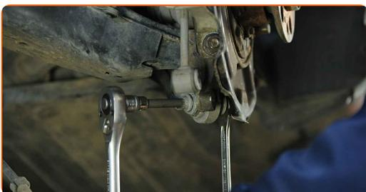
**28** Rimuovi i bulloni di fissaggio. Usa la chiave Torx M12. Usa una chiave a cricchetto.
