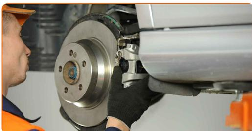
**87** Monta i bulloni di fissaggio (2 pezzi).
