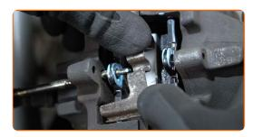
Installa il perno di fissaggio della pastiglia del freno. Usa un cacciaspina. Usa un martello.
