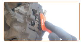
Rimuovi il perno di fissaggio della pastiglia freno. Usa un cacciaspina. Usa un martello.
