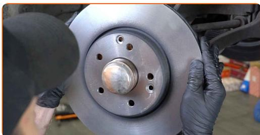
**21** Serrare l'attacco del disco freno. Usa la chiave Torx T30. Usa una chiave dinamometrica. Serralo fino allo coppia di torsione di 9 Nm.
