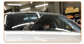
Dopo l'installazione, verificare il buon funzionamento del meccanismo tergicristallo. Le lame non devono intersecarsi o urtare contro la guarnizione del parabrezza.
