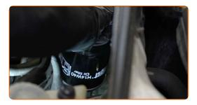
Stringere il filtro dell'olio. Prestare attenzione a rispettare la coppia di serraggio prescritta. Usa la bussola 76/14F. Usa una chiave dinamometrica. Serralo fino allo coppia di torsione di 20 Nm.
