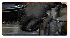
Far girare il motore per qualche minuto. Dopo che la spia di segnalazione luminosa della pressione dell'olio sarà spenta, spegni il motore.
