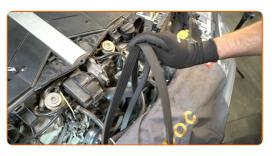
Sostituzione: cinghia poly-v - MERCEDES-BENZ Classe G SUV (W463). AUTODOC raccomanda:
