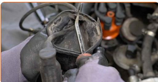
**18** Inserire il nuovo cavo ad alta tensione nel coperchio della bobina di accensione.
