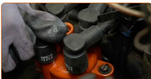
Sostituzione: cavi candele - MERCEDES-BENZ Classe G SUV (W463). Il consiglio degli esperti di AUTODOC:
