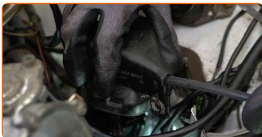
**21** Installare il supporto del cavo ad alta tensione.
