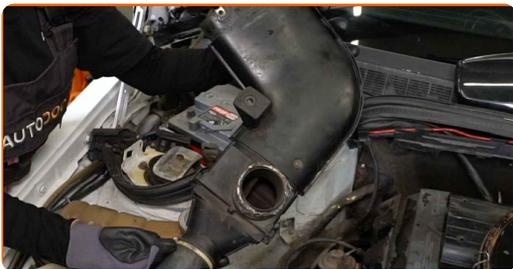
**7** Rimuovere il supporto del cavo ad alta tensione.
