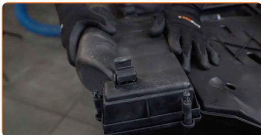
**15** Avvitare gli elementi di fissaggio dei coperchi del filtro dell'aria. Usa la chiave Torx T20. Usa una chiave a cricchetto.
