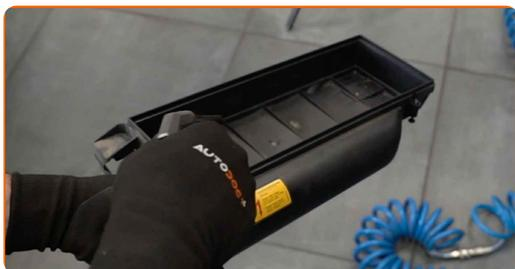
**13** Installare nuovi elementi filtranti. Assicurarsi che i bordi dei filtri si inseriscano perfettamente nell'alloggiamento.
