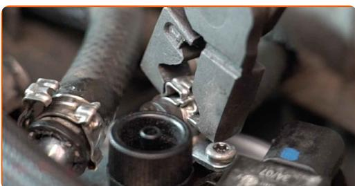
**20** Collega il connettore del sensore di presenza dell'acqua nel carburante.
