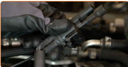
**7** Scollega il connettore del sensore di presenza dell'acqua nel carburante.
