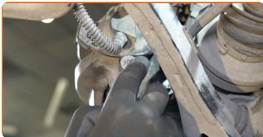
**35** Installare la molla di fissaggio della pinza freno.
