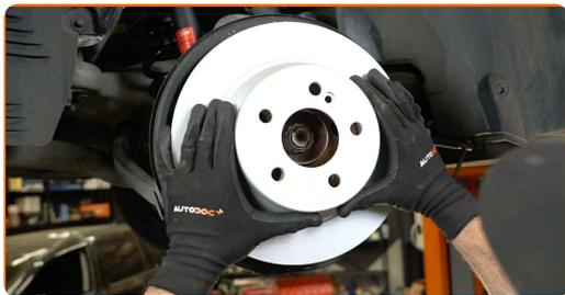
**27** Serrare l'attacco del disco freno. Usa la chiave Torx T30. Usa una chiave dinamometrica. Serralo fino allo coppia di torsione di 8 Nm.
