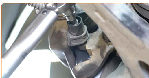
**34** Montare i tappi dei parapolvere delle guide pinza freno.
