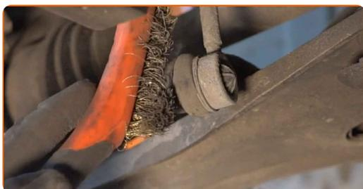
**7** Svita gli elementi di fissaggio che collegano il tirante della barra stabilizzatrice alla barra. Utilizza una chiave combinata N°16. Utilizza una chiave combinata N°22.
