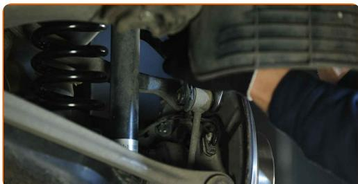
**8** Svita gli elementi di fissaggio che collegano il tirante della barra stabilizzatrice al fuso a snodo. Utilizza una chiave combinata N°16. Utilizza una chiave a bussola N°16. Usa una chiave a cricchetto.
