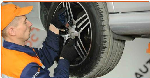
**6** Pulisci gli elementi di fissaggio dei tiranti delle barre stabilizzatrici. Usa una spazzola metallica. Usa lo spray WD-40.
