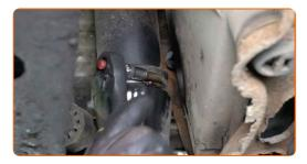
Rimuovere la clip inferiore del tubo dell'intercooler. Usa un piede di porco.
