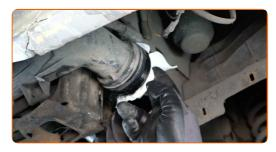
Pulire le sedi di montaggio del tubo dell'intercooler. Usa un detergente spray multiuso.
