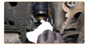
Installare il nuovo tubo dell'intercooler.
