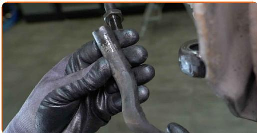
**12** Pulisci le sedi di montaggio delle testine tiranti dello sterzo. Usa una spazzola metallica. Usa lo spray WD-40.
