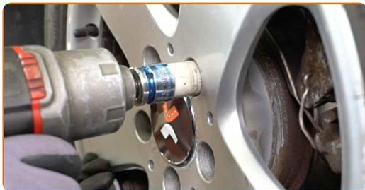
**24** Rimettere il veicolo per terra e, lavorando in ordine incrociato, serrare i bulloni di fissaggio delle ruote. Usa la chiave a bussola per dadi cerchio ruota n.17. Usa una chiave dinamometrica. Serralo fino allo coppia di torsione di 110 Nm.
