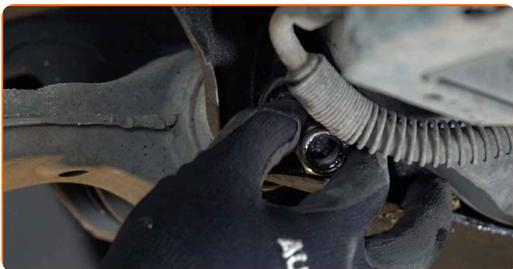
**21** Svita l'elemento di fissaggio posteriore del braccio. Utilizza una chiave combinata N°22 (2 pezzi).
