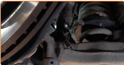
**19** Svita l'elemento di fissaggio anteriore del braccio. Utilizza una chiave combinata N°22 (2 pezzi).
