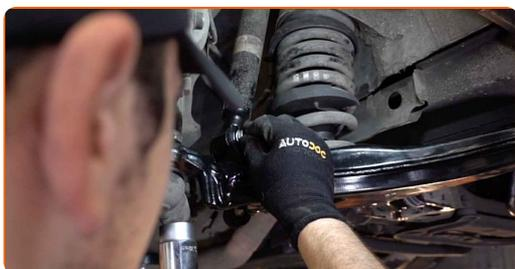
**42** Serra il dado di fissaggio del giunto sferico. Utilizza una chiave combinata N°22.
