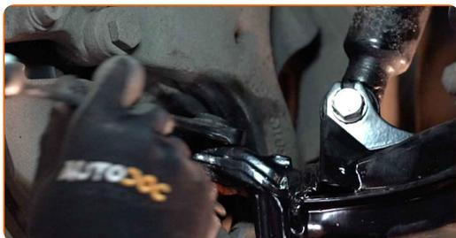
**43** Solleva il cric idraulico per trasmissione di 10-15 cm.
