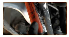
Installare una nuova barra, serrarne gli elementi di montaggio. Usa un piede di porco.
