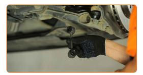
Serra l'elemento di fissaggio che collega la barra stabilizzatrice con il braccio di sospensione. Usa un piede di porco. Usa la chiave Torx T50. Usa una chiave dinamometrica. Serralo fino allo coppia di torsione di 80 Nm.
