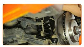
Pulisci le sedi di montaggio del tirante della barra stabilizzatrice. Usa una spazzola metallica. Usa lo spray WD-40.
