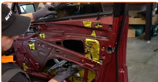
Sostituzione: alzacrystalli - MERCEDES-BENZ Classe E T-modell (S124). Gli esperti di AUTODOC raccomandano:
