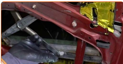
Sostituzione: alzacristalli - MERCEDES-BENZ Classe E T-modell (S124).
