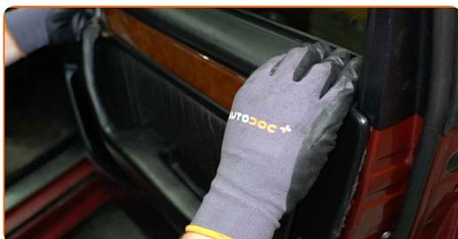
**33** Installare il rivestimento dello specchietto retrovisore laterale.
