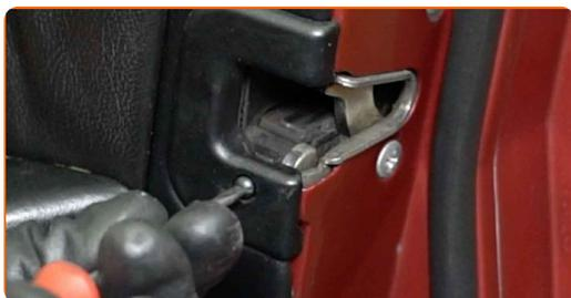
**36** Serrare l'elemento di fissaggio del pannello della portiera. Utilizza una chiave a bussola N°10. Usa una chiave dinamometrica. Serralo fino allo coppia di torsione di 8 Nm.
