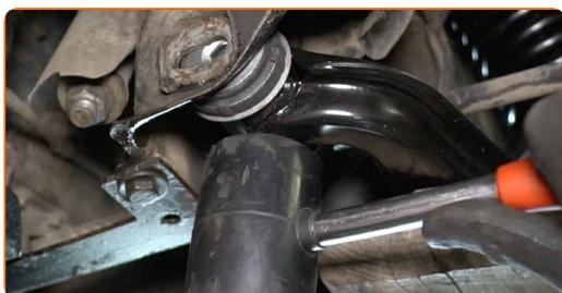
**27** Monta i bulloni di fissaggio. Usa un martello di gomma.
