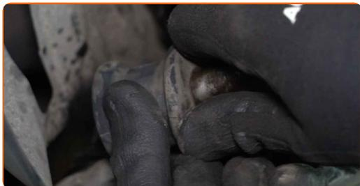
**14** Svitare l'elemento di fissaggio che collega il giunto sferico al fuso a snodo dello sterzo. Utilizza una chiave combinata N°18. Utilizza una chiave a bussola N°19. Usa una chiave a cricchetto.
