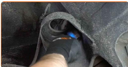
**34** Pulisci le sedi di montaggio dell'ammortizzatore. Usa una spazzola metallica. Usa un detergente spray multiuso.
