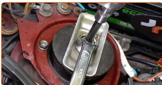
**Sostituzione: ammortizzatore a molla - MERCEDES-BENZ Classe E T-modell (S124). Consiglio:**
