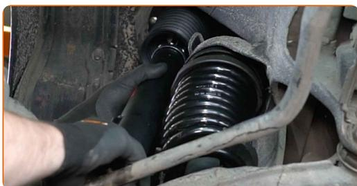
Sostituzione: ammortizzatore a molla - MERCEDES-BENZ Classe E T-modell (S124). Il consiglio degli esperti di AUTODOC:
