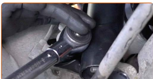
**44** Rimuovere il supporto da sotto il fuso a snodo dello sterzo.
