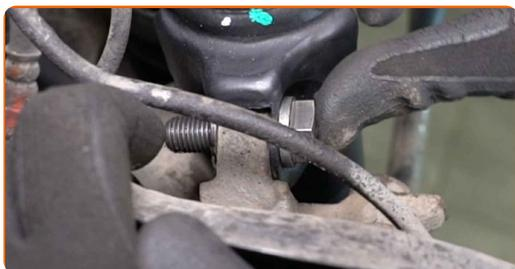
**43** Serrare gli elementi di fissaggio inferiori degli ammortizzatori. Utilizza una chiave a bussola N°19. Usa una chiave dinamometrica. Serralo fino allo coppia di torsione di 110 Nm.
