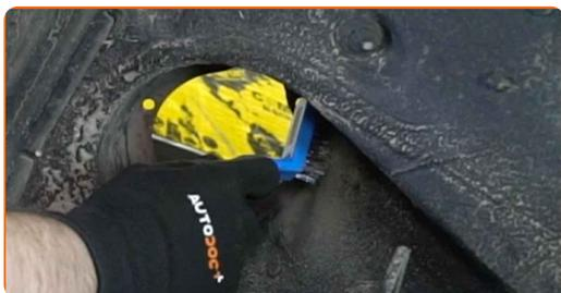
**35** Pulire la sede di montaggio del supporto del puntone di sospensione. Usa una spazzola metallica. Usa un detergente spray multiuso.
