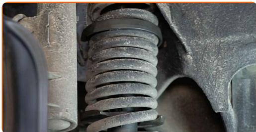
Sostituzione: ammortizzatore a molla - MERCEDES-BENZ Classe E T-modell (S124). AUTODOC raccomanda:
