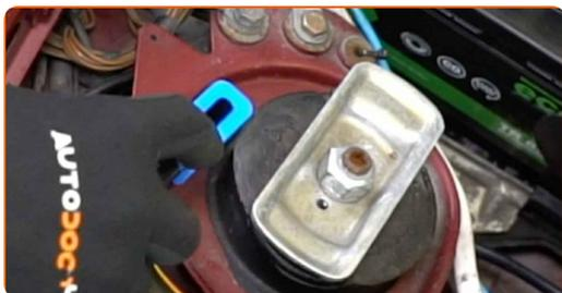
**4** Pulisci l'elemento di fissaggio dell'asta dell'ammortizzatore. Usa una spazzola metallica. Usa lo spray WD-40.
