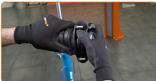
**38** Avvitare gli elementi di fissaggio del supporto superiore del puntone.
