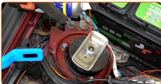
**5** Allentare gli elementi di fissaggio del supporto superiore del puntone. Utilizza una chiave a bussola N°13. Usa una chiave a cricchetto.
