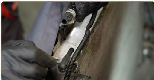
**22** Pulire l'elemento di fissaggio della linea di raffreddamento inferiore del fluido di trasmissione automatica. Usa una spazzola metallica. Usa lo spray WD-40.
