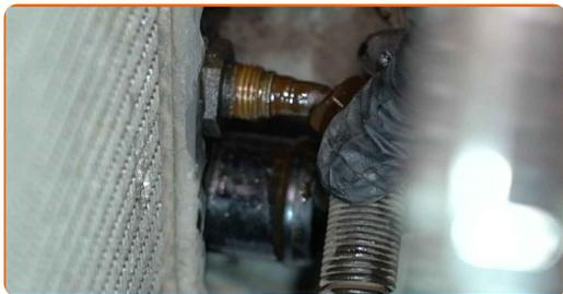
**29** Rimuovere le clip di fissaggio superiori del radiatore del motore. Usa uno strumento per estrazione clip.
