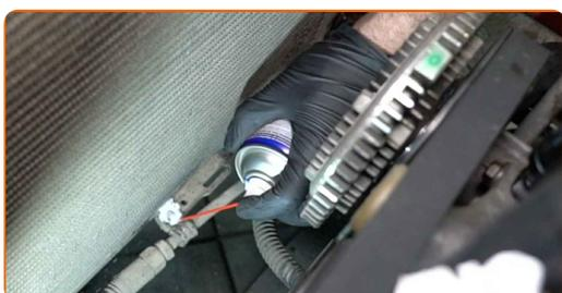
**23** Svitare l'elemento di fissaggio della linea di raffreddamento inferiore del fluido di trasmissione automatica. Utilizza una chiave a bussola N°10. Usa una chiave a cricchetto.
