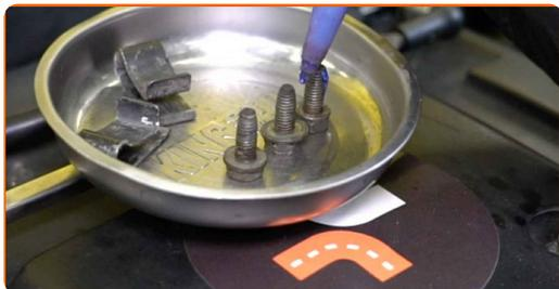
**41** Serrare gli elementi di fissaggio della ventola. Utilizza una chiave a bussola N°10. Usa una chiave dinamometrica. Serralo fino allo coppia di torsione di 10 Nm.
