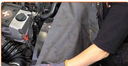
**3** Pulire la staffa di montaggio del filtro carburante. Usa un detergente spray multiuso.
