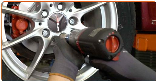
**21** Rimettere il veicolo per terra e, lavorando in ordine incrociato, serrare i bulloni di fissaggio delle ruote. Usa la chiave a bussola per dadi cerchio ruota n.17. Usa una chiave dinamometrica. Serralo fino allo coppia di torsione di 110 Nm.
