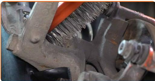
**16** Svitare gli elementi di fissaggio del supporto della pinza del freno. Utilizza una chiave a bussola N°19. Usa una chiave a cricchetto.
