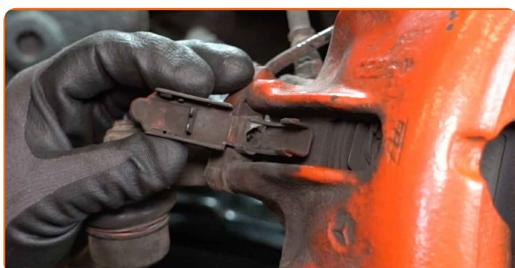
**9** Pulisci gli elementi di fissaggio della pinza freno. Usa una spazzola metallica. Usa lo spray WD-40.
