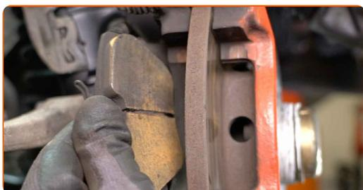
**15** Pulisci gli elementi di fissaggio del supporto pinza freno. Usa una spazzola metallica. Usa lo spray WD-40.
