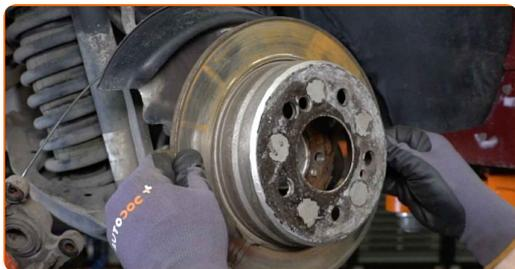
**22** Rimuovere la molla di ritorno della ganasce inferiore del freno. Usa un giravite piatto.
