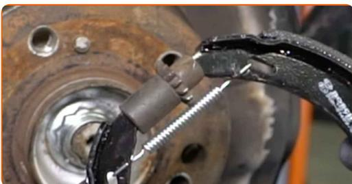
**31** Installare le nuove ganasce del freno di stazionamento.
