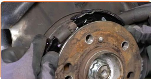
**32** Installare le molle di fermo delle ganasce del freno di stazionamento. Utilizzare pinze a naso lungo.
