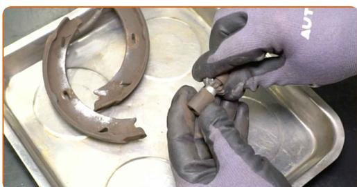
**27** Pulire il regolatore del freno di stazionamento. Usa una spazzola metallica. Usa un detergente spray multiuso.
