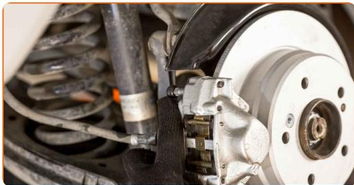
Sostituzione: pinza de freno - MERCEDES-BENZ Classe E Sedan (W124).
