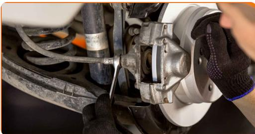
**13** Pulisci gli elementi di fissaggio della pinza freno. Usa una spazzola metallica. Usa lo spray WD-40.
