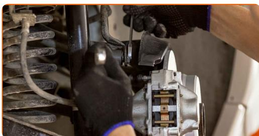
**15** Installare l'elemento di fissaggio che congiunge il collegamento dello stabilizzatore al braccio di controllo e serrarlo. Utilizza una chiave combinata N°13. Utilizza una chiave a bussola N°13. Utilizza una chiave a bussola N°17. Usa una chiave dinamometrica. Serralo fino allo coppia di torsione di 20 Nm.
