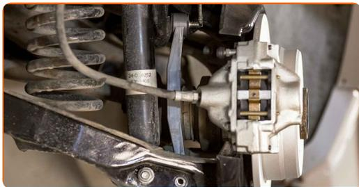
**14** Serra gli elementi di fissaggio che collegano il tirante della barra stabilizzatrice alla barra. Utilizza una chiave combinata N°17. Utilizza una chiave combinata N°19. Usa una chiave dinamometrica. Serralo fino allo coppia di torsione di 30 Nm.
