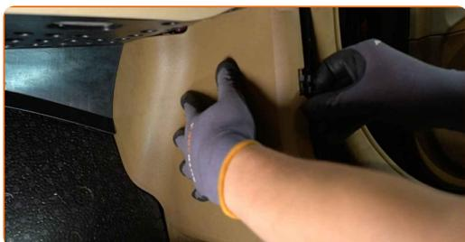
**14** Installare la guarnizione interna della portiera.
