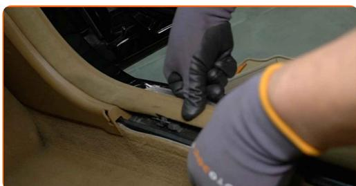
**15** Installare la copertura interna del battitacco della portiera.
