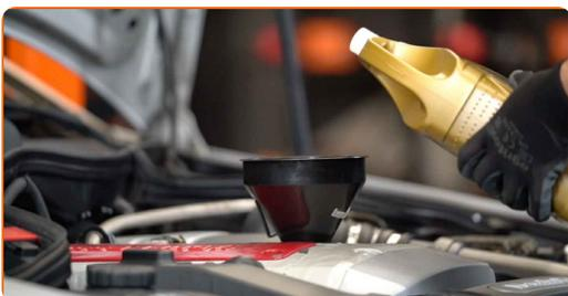
Sostituzione: olio motore e filtro - MERCEDES-BENZ Classe E Coupe (C124).
