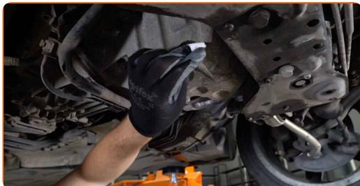
**21** Avvita il nuovo tappo di drenaggio e stringerlo. Utilizza una chiave a bussola N°24. Usa una chiave dinamometrica. Serralo fino allo coppia di torsione di 30 Nm.
