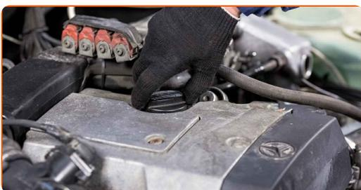
**4** Svitare il tappo dell'alloggiamento del filtro insieme al vecchio elemento filtrante. Usa la bussola 62-23F. Usa una chiave a cricchetto.
