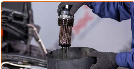
**Sostituzione: olio motore e filtro - MERCEDES-BENZ Classe E Coupe (C124). Il consiglio degli esperti di AUTODOC:**
