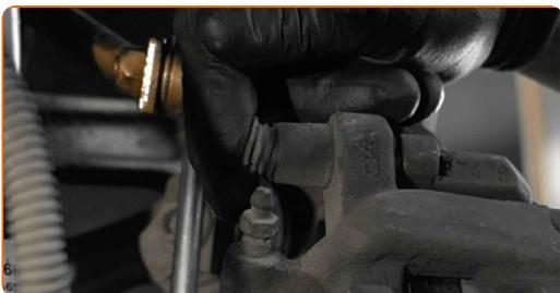
**27** Collegare il cablaggio del sensore di usura delle pastiglie dei freni.
