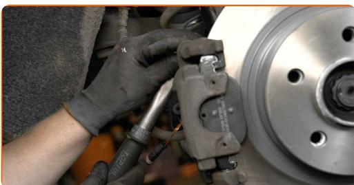
**26** Montare i tappi dei parapolvere delle guide pinza freno.
