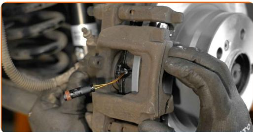
**25** Serra gli elementi di fissaggio della pinza del freno. Usa una chiave HEX N.H7. Usa una chiave dinamometrica. Serralo fino allo coppia di torsione di 25 Nm.
