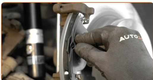
**24** Montare la pinza del freno e fissarla.
