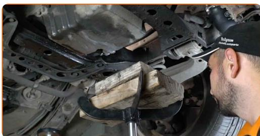
Sostituzione: supporto motore - MERCEDES-BENZ Classe E Camion pianale / Telaio (VF210). I professionisti raccomandano:
