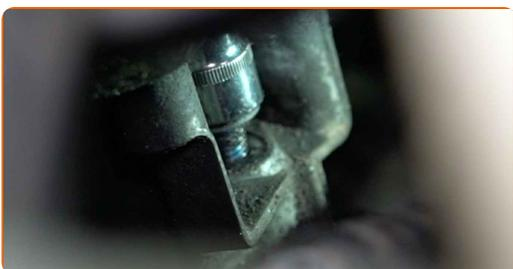
**6** Rimuovi i bulloni di fissaggio. Usa un magnete telescopico.
