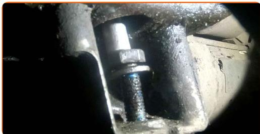
**7** Svita gli elementi di fissaggio inferiori del supporto del motore. Utilizza una chiave a bussola N°13. Usa una chiave a cricchetto.
