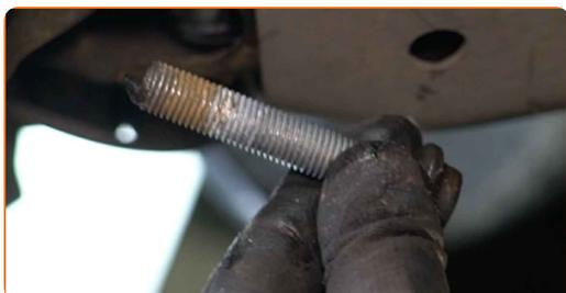
**11** Pulire gli elementi di fissaggio del supporto del sottotelaio. Usa una spazzola metallica. Usa lo spray WD-40.
