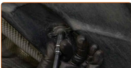
**35** Installare la copertura in plastica del braccio della sospensione.
