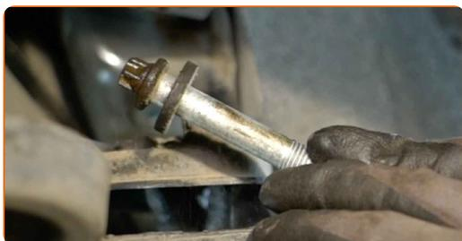
**15** Rimuovere il supporto del sottotelaio.
