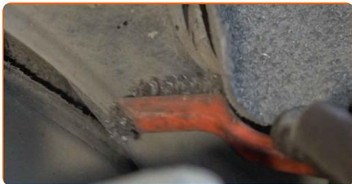
**12** Sorreggere il sottotelaio. Usa un cric idraulico per trasmissione.
