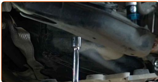
**13** Svitare gli elementi di fissaggio del supporto del sottotelaio. Si tratta di un'operazione necessaria per accedere al bullone di fissaggio superiore del braccio della sospensione. Usa la chiave Torx E10. Usa la chiave Torx E14. Usa una chiave a cricchetto.
