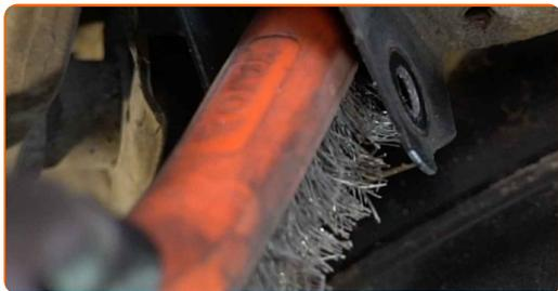
**20** Pulire le sedi di montaggio del supporto del sottotelaio. Usa una spazzola metallica. Usa lo spray WD-40.
