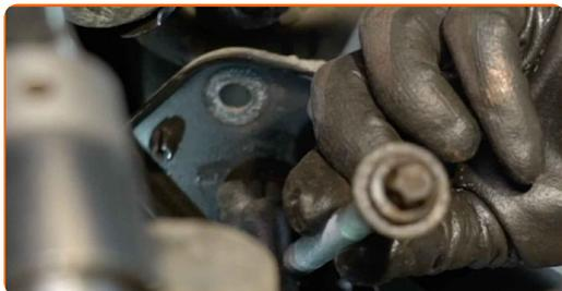
**16** Svitare l'elemento di fissaggio che collega il braccio di controllo al sottotelaio. Utilizza una chiave combinata N°18. Usa la chiave XZN n.12. Usa una chiave a cricchetto.
