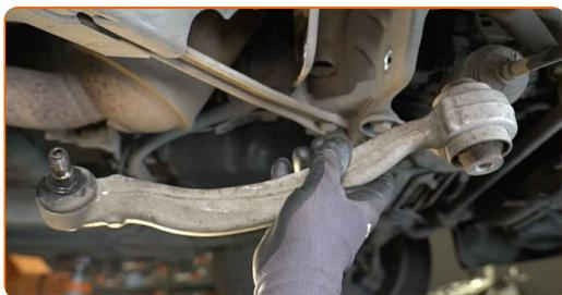
**14** Pulire le sedi di montaggio del braccio della sospensione. Usa una spazzola metallica. Usa lo spray WD-40.
