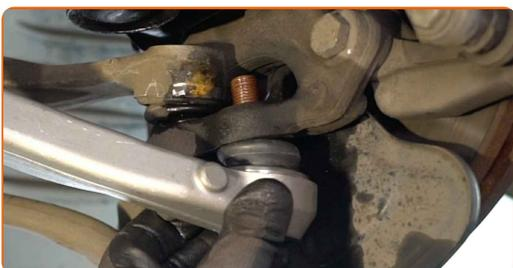
**18** Puntellare il fuso a snodo. Usa un cric idraulico per trasmissione.
