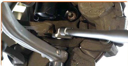
**20** Stringere l'elemento di fissaggio che collega il braccio di controllo al sottotelaio. Utilizza una chiave combinata N°21. Usa la chiave Torx E20. Usa una chiave dinamometrica. Serralo fino allo coppia di torsione di 80 Nm. +120°
