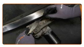
Pulire gli elementi di fissaggio del motorino del tergicristallo. Usa una spazzola metallica. Usa lo spray WD-40.
