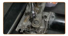
Svitare gli elementi di fissaggio del motorino del tergicristallo. Utilizza una chiave a bussola N°10. Usa una chiave a cricchetto.
