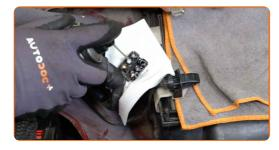
Pulire la sede di montaggio del meccanismo del tergicristallo. Usa una spazzola metallica. Usa un detergente spray multiuso.
