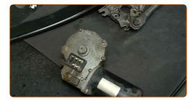
Pulire la sede di montaggio del motorino del tergicristallo. Usa una spazzola metallica. Usa un detergente spray multiuso.
