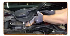
Installare la parte centrale dello scarico.
