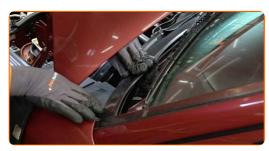
Installare l'elemento centrale che trattiene la guarnizione del pannello di copertura del parabrezza.
