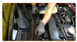
Rimuovere l'elemento centrale che trattiene la guarnizione del pannello di copertura del parabrezza.
