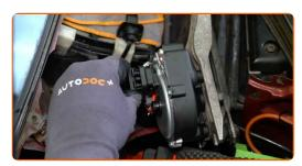
Serrare gli elementi di fissaggio del meccanismo del tergicristallo. Utilizza una chiave a bussola N°10. Usa una chiave dinamometrica. Serralo fino allo coppia di torsione di 13 Nm.
