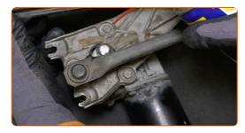
Svitare l'elemento di fissaggio che collega il leveraggio all'albero del motorino del tergicristallo. Utilizza una chiave a bussola N°13. Usa una chiave a cricchetto.
