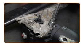
Installare il leveraggio del tergicristallo sull'albero del motorino. Utilizzare un righello.
