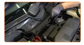
Montare la guarnizione del pannello di copertura del tergicristalli.
