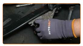
Serrare gli elementi di fissaggio del motorino del tergicristallo. Utilizza una chiave a bussola N°10. Usa una chiave dinamometrica. Serralo fino allo coppia di torsione di 13 Nm.
