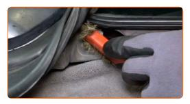
Svitare gli elementi di fissaggio del meccanismo del tergicristallo. Utilizza una chiave a bussola N°10. Usa una chiave a cricchetto.
