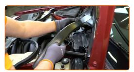
Svitare gli elementi di fissaggio dello scarico. Usa un cacciavite Phillips.
