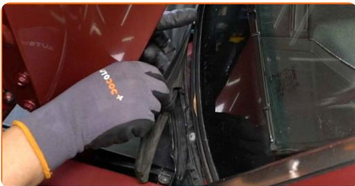
**5** Svitare gli elementi di fissaggio dello scarico. Usa un cacciavite Phillips.
