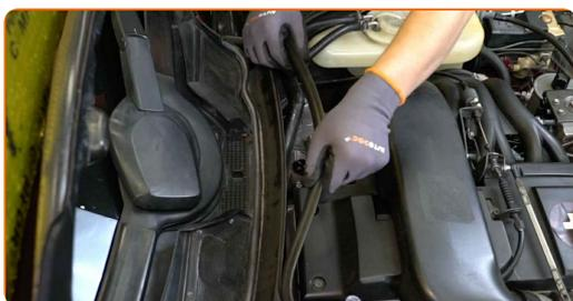
**3** Rimuovere l'elemento centrale che trattiene la guarnizione del pannello di copertura del parabrezza.
