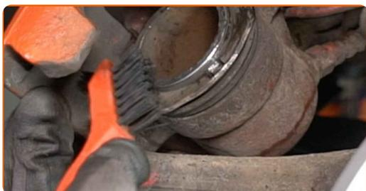
**17** Premere il pistone della pinza del freno. Usa un arretratore per pistoncini freni a disco.
