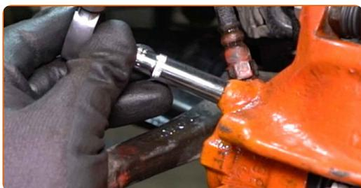
**61** Collega il tappo della vite di spurgo della pinza freno.
