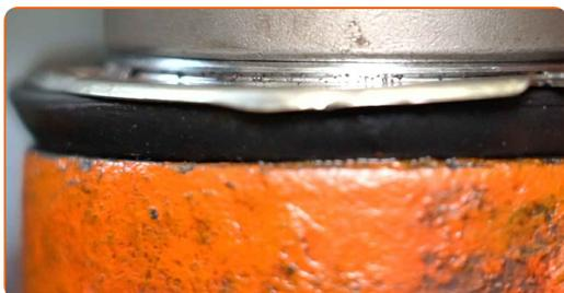
**41** Installa i nuovi parapolveri dei perni guida della pinza del freno.
