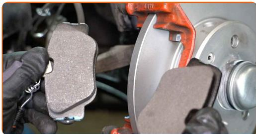
**23** Pulisci gli elementi di fissaggio del supporto pinza freno. Usa una spazzola metallica. Usa lo spray WD-40.
