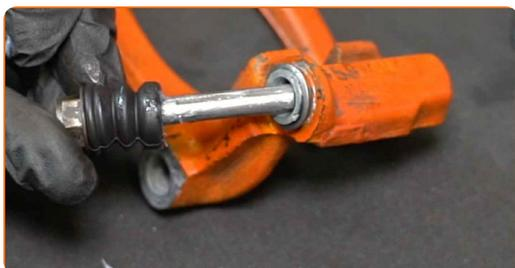
**42** Tratta i perni guida della pinza del freno con il prodotto. Usa il grasso per il perno guida della pinza del freno.
