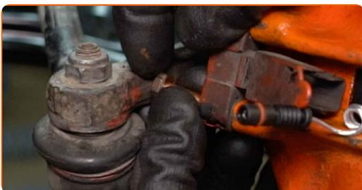
**64** Avvitare l'elemento di fissaggio del connettore del sensore di usura delle pastiglie dei freni. Utilizza una chiave combinata N°10.
