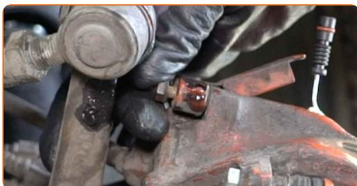
**12** Staccare il connettore del sensore di usura delle pastiglie dei freni.
