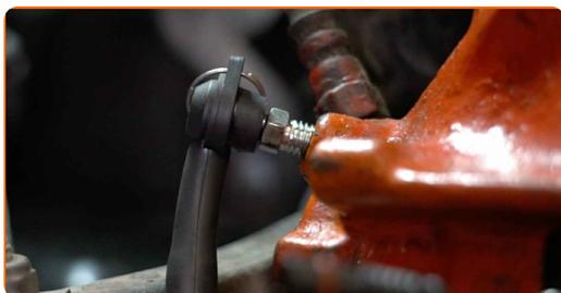
**59** Disconnetti il tubo flessibile del kit di spurgo freno pneumatico.
