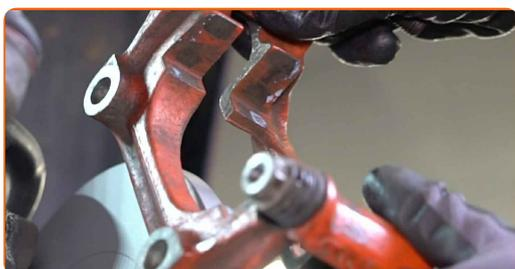
**27** Rimuovere la piastra protettiva che copre il soffietto parapolvere del pistone della pinza. Usa un giravite piatto.
