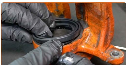
Sostituzione: kit di revisione delle pinze freno - MERCEDES-BENZ Classe E Cabrio (A124). Gli esperti di AUTODOC raccomandano:
