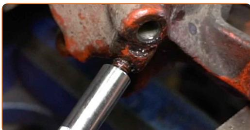
**31** Rimuovere il soffietto parapolvere del pistone della pinza del freno.
