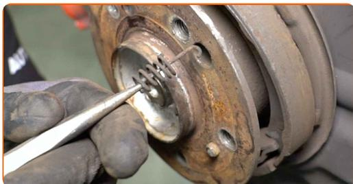
**24** Rimuovere le ganasce del freno di stazionamento.
