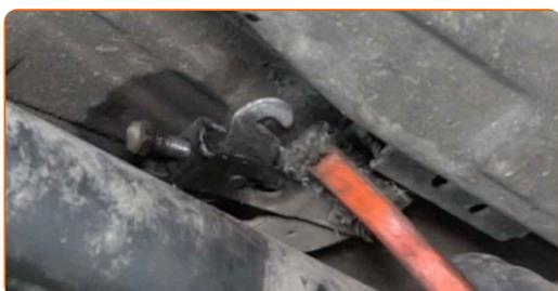
**36** Installare un nuovo cavo del freno di stazionamento. Usa un martello.
