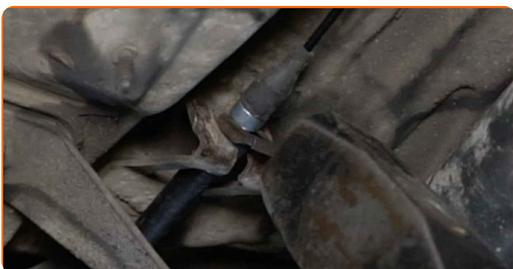
**38** Installare il perno che collega il cavo al grillo della ganaschia del freno di stazionamento.
