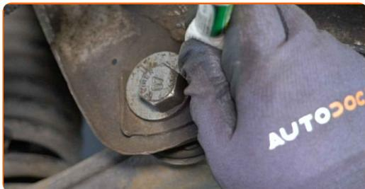
**16** Svitare il fissaggio anteriore del braccio di controllo. Utilizza una chiave combinata N°22. Utilizza una chiave a bussola N°22. Usa una chiave a cricchetto.
