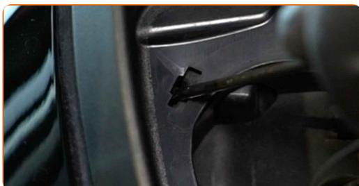
**10** Rimuovere il telaio della copertura dello specchietto.
