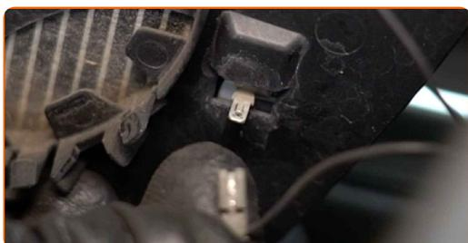
**8** Svitare gli elementi di fissaggio del telaio della copertura dello specchietto. Usa la chiave Torx T10.
