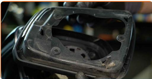
**11** Rilasciare le linguette del telaio della copertura dello specchietto. Usa un attrezzo di plastica per la rimozione finiture auto.
