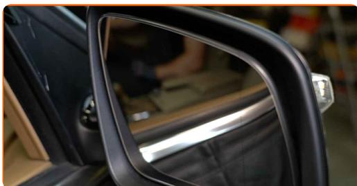
**31** Controllare il funzionamento della luce del ripetitore dell'indicatore di direzione.
