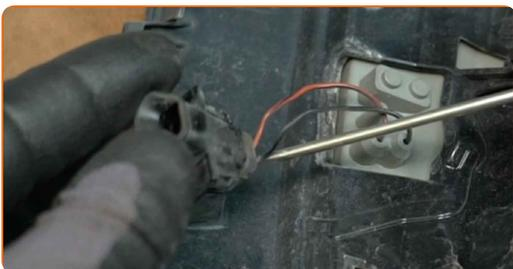
**14** Svitare gli elementi di fissaggio del ripetitore dell'indicatore di direzione dalla copertura dello specchietto. Usa la chiave Torx T10.
