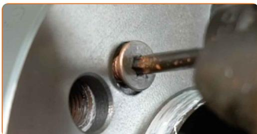
**31** Serrare l'attacco del disco freno. Usa la chiave Torx T30. Usa una chiave dinamometrica. Serralo fino allo coppia di torsione di 10 Nm.
