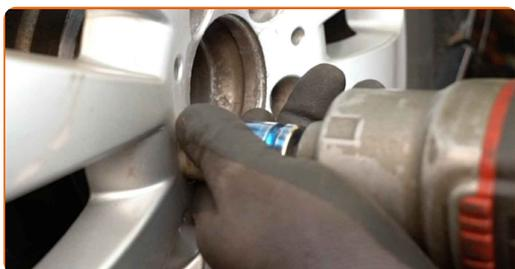
**53** Rimettere il veicolo per terra e, lavorando in ordine incrociato, serrare i bulloni di fissaggio delle ruote. Usa la chiave a bussola per dadi cerchio ruota n.17. Usa una chiave dinamometrica. Serralo fino allo coppia di torsione di 130 Nm.
