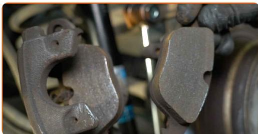
**18** Pulisci gli elementi di fissaggio del supporto pinza freno. Usa una spazzola metallica. Usa lo spray WD-40.
