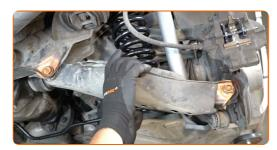
Avvita gli elementi di fissaggio del coperchio di plastica del braccio di sospensione. Utilizza una chiave a bussola N°10. Usa una chiave a cricchetto.
