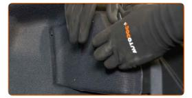
Installa la copertura centrale di protezione in plastica.
