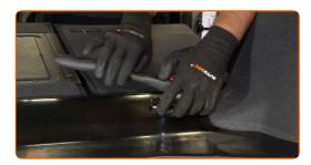
Rimuovi la copertura centrale di protezione in plastica.
