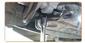
Stringi l'elemento di fissaggio inferiore dell'ammortizzatore. Utilizza una chiave combinata N°16. Utilizza una chiave a bussola N°16. Usa una chiave dinamometrica. Serralo fino allo coppia di torsione di 55 Nm.
