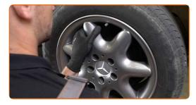
Svita gli elementi di fissaggio del coperchio di plastica del braccio di sospensione. Utilizza una chiave a bussola N°10. Usa una chiave a cricchetto.
