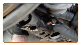
Avvita gli elementi di fissaggio inferiori dell'ammortizzatore. Utilizza una chiave combinata N°16. Utilizza una chiave a bussola N°16. Usa una chiave a cricchetto.
