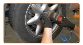
Rimettere il veicolo per terra e, lavorando in ordine incrociato, serrare i bulloni di fissaggio delle ruote. Usa la chiave a bussola per dadi cerchio ruota n.17. Usa una chiave dinamometrica. Serralo fino allo coppia di torsione di 110 Nm.
