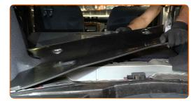
Rimuovi le clip del rivestimento laterale del cofano. Usa uno strumento per estrazione clip.
