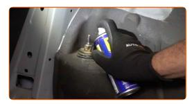
Svita l'elemento di fissaggio superiore dell'ammortizzatore. Utilizza una chiave combinata N°17. Usa la chiave a bussola per ammortizzatore Nr. DD6. Usa una chiave a cricchetto.
