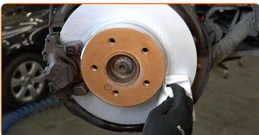
Sostituzione: dischi freni - MERCEDES-BENZ Classe C T-modell (S203).
