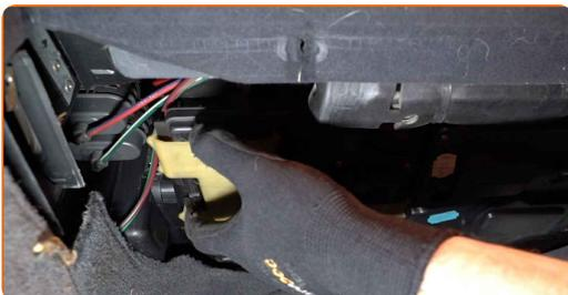
**6** Rimuovi gli elementi di fissaggio dei filtri dell'aria abitacolo di ricircolo dall' alloggiamento del climatizzatore.
