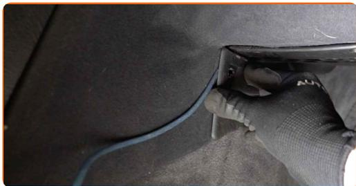
**10** Avvita gli elementi di fissaggio della copertura in plastica laterale. Usa un cacciavite Phillips.
