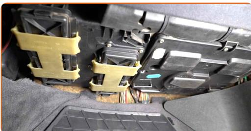
**9** Installa la copertura in plastica laterale. Posiziona il pezzo usando le guide e serra gli elementi di fissaggio.
