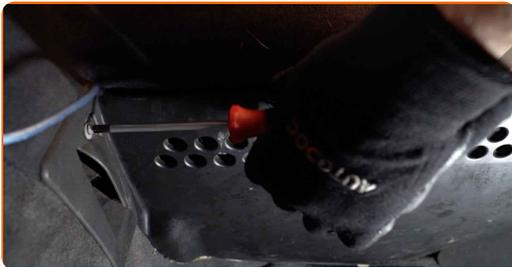
**4** Fai leva, delicatamente allenta gli elementi di fissaggio e rimuovi la copertura in plastica del lato passeggero.
