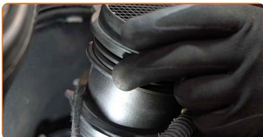
**14** Installare un nuovo sensore del flusso d'aria di massa. Assicurati di sentire un clic indicante che si trova installato saldamente.
