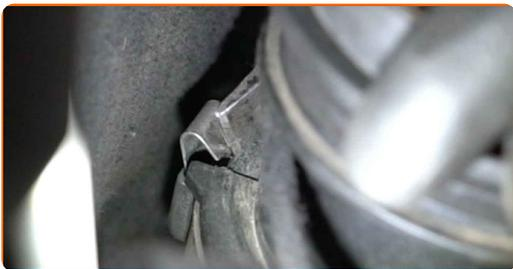
**13** Rimuovere il sensore del flusso d'aria di massa.
