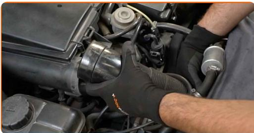
**5** Pulisci il coperchio del filtro dell'aria e l'alloggiamento.
